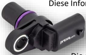
Diese Sensoren arbeiten nach dem Hall-Prinzip. Dabei wird ein mit der Nockenwelle verbundener Zahnkranz abgetastet. Um die Position festzustellen, werden bestimmte Zähne weggelassen oder ein Zahn markiert den oberen Totpunkt (OT) für Zylinder eins.
