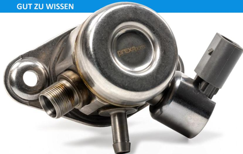
Die Entwicklung von immer leistungsfähigeren und gleichzeitig sparsameren Benzinmotoren machte den Einsatz der Kraftstoff-Direkteinspritzung auch in Ottomotoren notwendig. Daher sind Hochdruckpumpen im Kraftstoff-System heutzutage der Standard.
